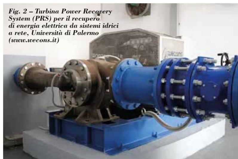
**Fig. 2 – Turbina Power Recovery System (PRS) per il recupero di energia elettrica da sistemi idrici a rete, Università di Palermo ([www.vecons.it](http://www.vecons.it))**
